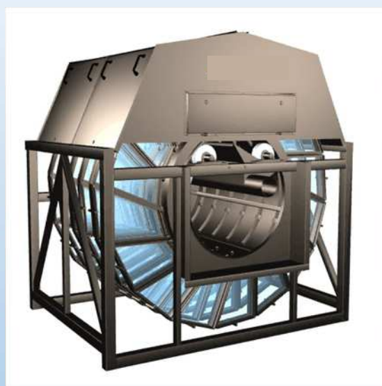
名城水処理センターのろ過装置（ディスクフィルタ）のイメージ図
